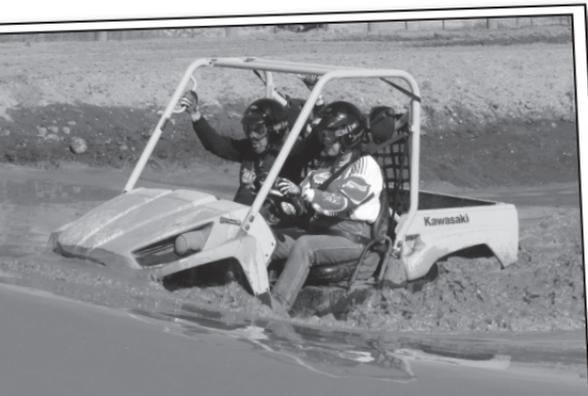
Mantenga el movimiento constante hacia delante para mantener la ola delante de usted. Esto creará una depresión poco profunda en el agua alrededor de su ROV evitando que el agua entre en la cabina y sature los componentes electrónicos.
